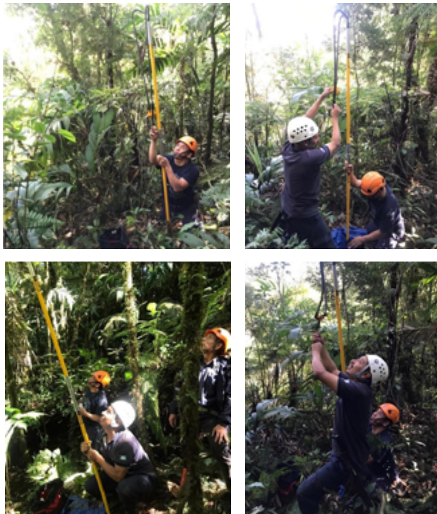
Figura No. 2: Uso de la resortera, el peso y la línea de cuerda para subir las grabadoras autónomas de sonido a los árboles de interés para realizar monitoreo acústico de quetzales en el marco del proyecto Findecyt/GeneraCYT 02-2022.
