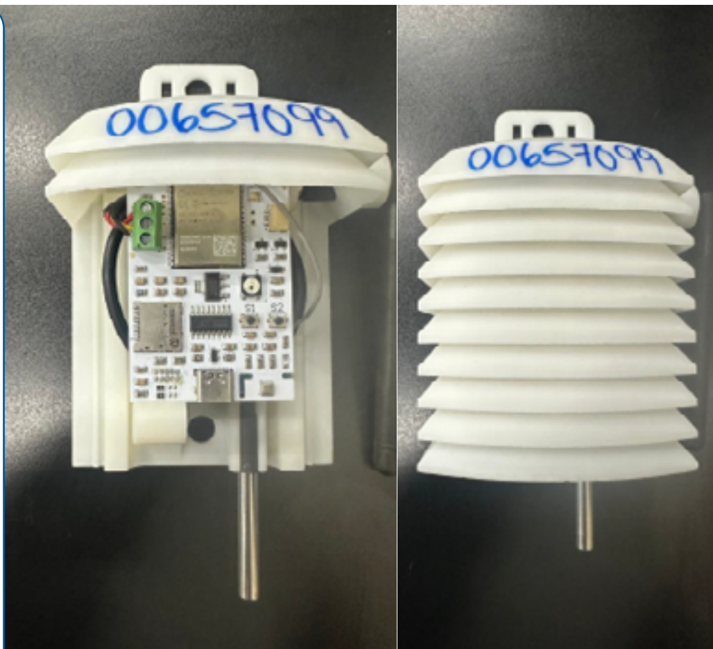
Figura No. 2: Encapsulado y tarjeta que integra la estación
